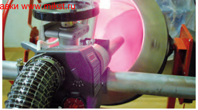
Сушка и выравнивание поверхности таблеток, драже, леденцов
