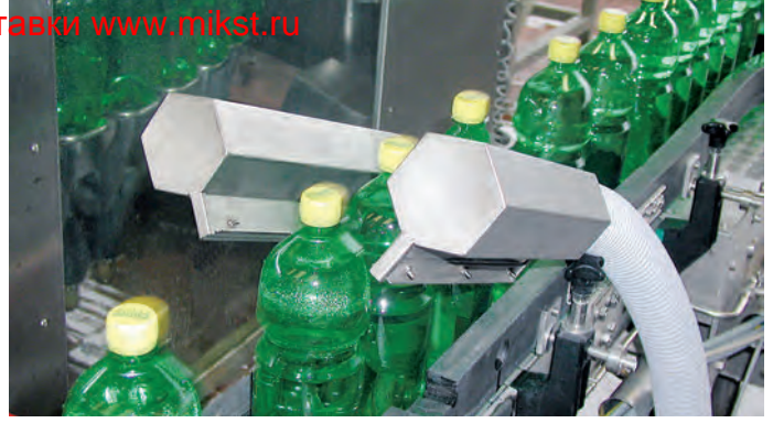
Вентилятор с аэроножами для сушки быстро и эффективно удаляет капли воды с поверхности бутылок
