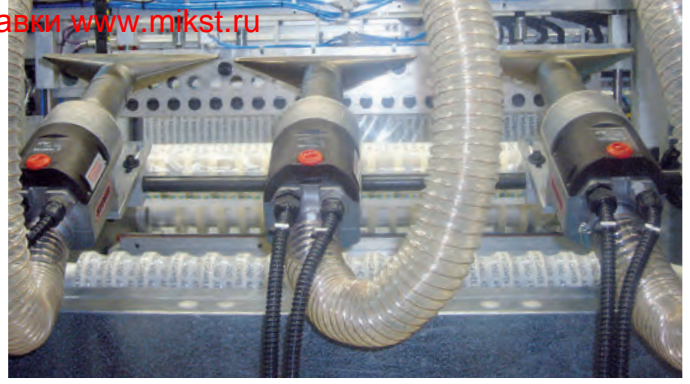
Три воздушнонагревателя LHS 61S с широкими щелевыми насадками в упаковочной линии
