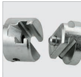
Муфта с Т-образным пазом, скосы облегчают сцепление
