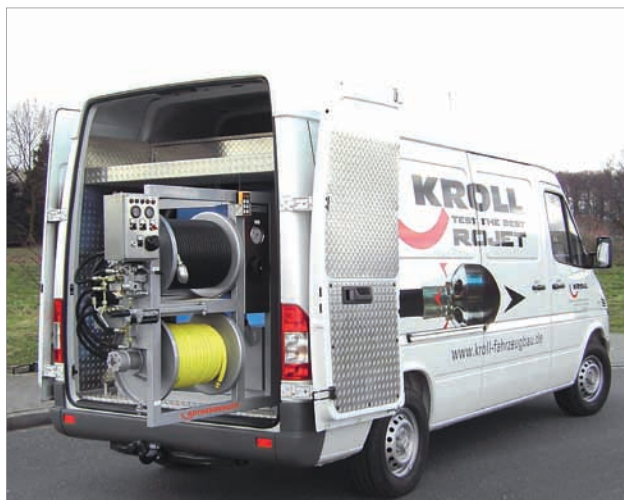
Комфортное исполнение - поворотный держатель для барабана
