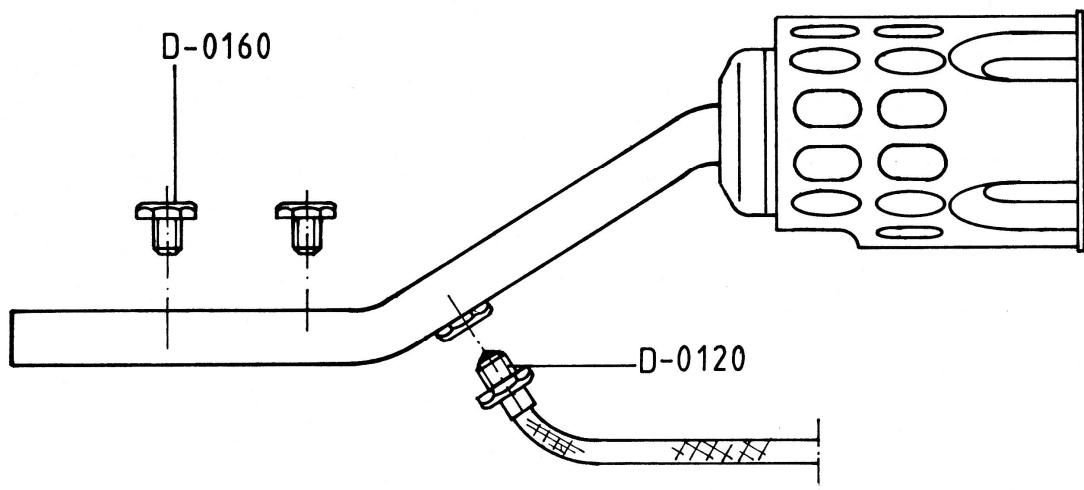
Трубка горячего воздуха для 5002CS, арт.№ D-0646
