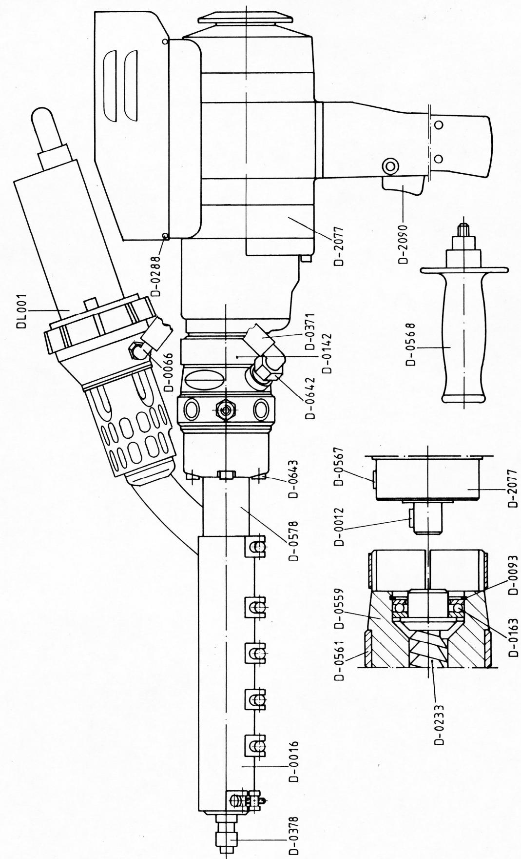
Трубка горячего воздуха для 5002 С, арт.№ D-0085
