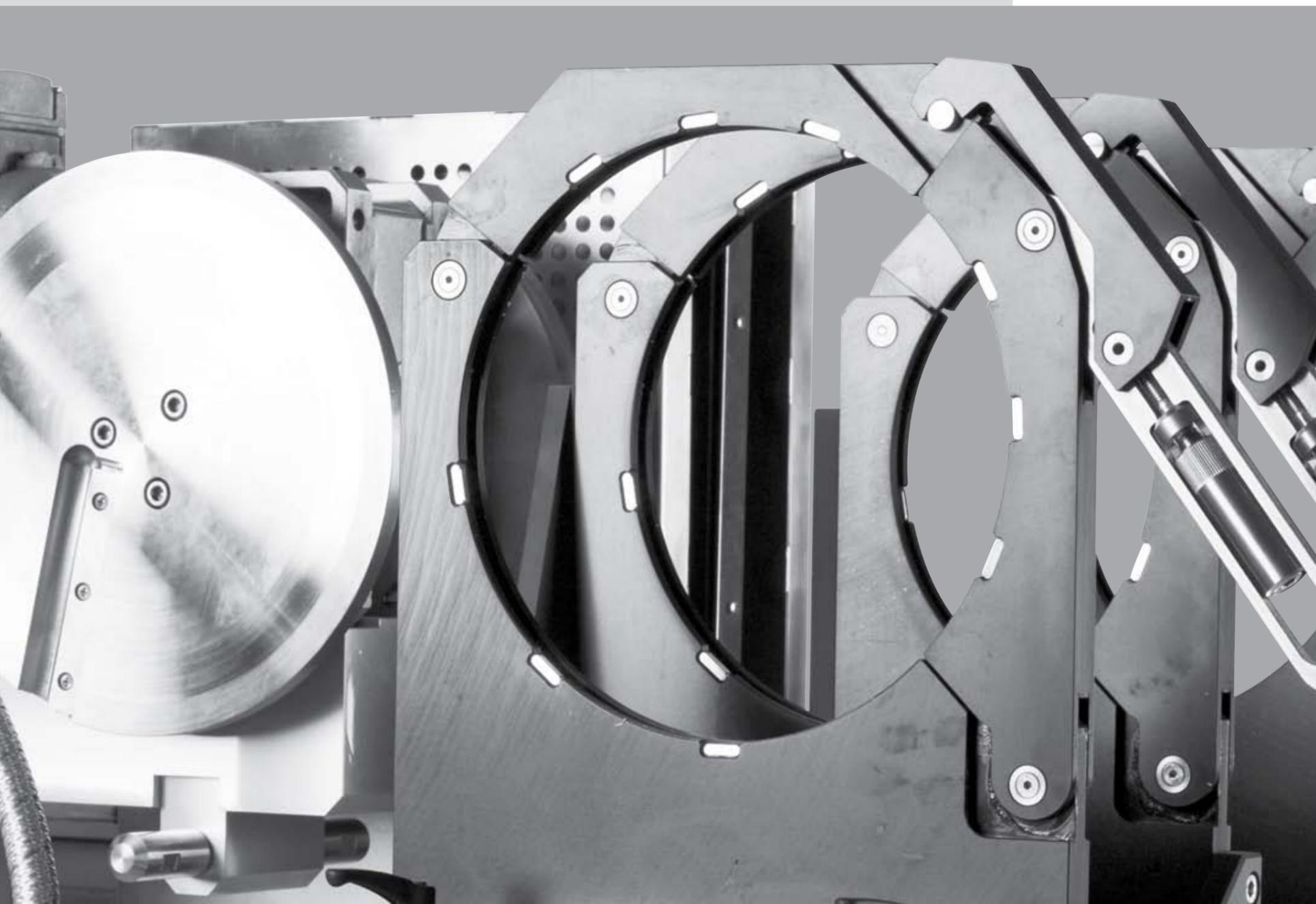
Цеховая машина **HÜRNER** HWT разработана для промышленного производства отводов, Т-образных тройников, крестовин и Y-образных тройников, а также для производителей технических конструкций и проектировщиков.
