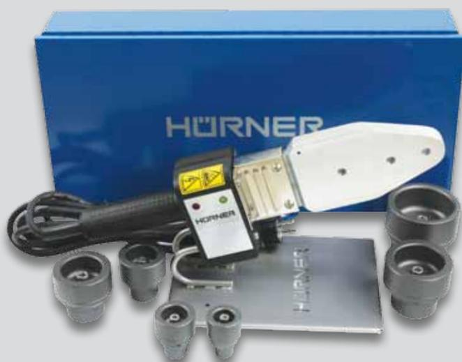
Аппараты **HÜRNER** для сварки внахлест с эргономичной ручкой предназначены для крепления нагревательных насадок: оправок и муфт различных диаметров. Позволяют устанавливать одновременно 2 или 3 комбинации насадок для сварки муфт, труб и фасонных деталей до Ø 125 мм. Оснащены переключателем температуры, контроллером питания, контроллером интервалов нагрева и поставляется вместе с подставкой с зажимом в красивом металлическом чемоданчике.
