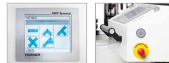
Все машины серийного производства поставляются с цветным тачскрин-дисплеем новейшего поколения, имеющим высокое разрешение. Данное устройство показывает и позволяет вводить все требуемые параметры трубы, а также необходимые для контроля данные.
