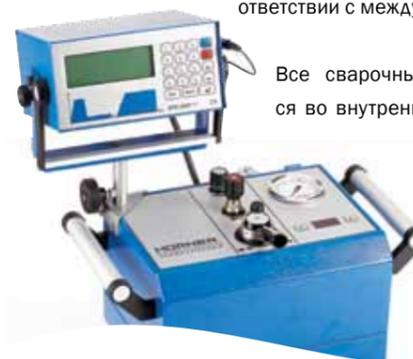
Все сварочные параметры записываются во внутреннюю память аппарата и могут передаваться напрямую с помощью двух USB-разъемов на USB-
