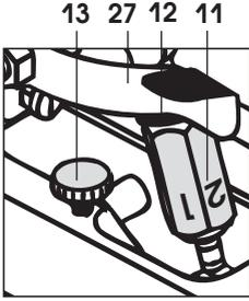
Otomatik kaynak makinasını kaynatılacak malzemenin üzerine yerleştirin. Kombi kamayı malzeme içine sokmadan **basınç kolunu (10)** sıkıştırın. **Basınç ayar vidası ile (11)** yürütme / baskı merdanelerini (22/23) malzemeye hafifçe değene kadar sıkın. **Kilit kolunu (27)** açarak **basınç kolunu (10)** geri çekin
