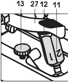
Hitsausautomaatti työnnetään sisään hitsattavaan materiaaliin ja paikoitetaan. **Kiristysvipu (10)** kiristetään kiilasuutinta sisäänvetämättä. **Käyttö-/puristusrullat (22/23)** saatetaan **säätömutterin (11)** avulla kevyesti kosketukseen hitsattavan materiaalin kanssa. **Kiristysvivun lukitus (27)** vapautetaan ja samalla poistetaan **kiristysvivun (10)** jännitys.
