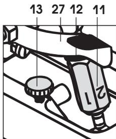
Najet svářečkou do svařovaného materiálu a upravit její polohu. Bez uvolnění **napínací páky (10)** nelze kombinovaný klín zasunout do pracovní polohy. Otáčením **stavěcí matice (11)** lehce nastavit mírný dotyk **pohonných a přitlačných válečků (22/23)** se svařovaným materiálem. Uvolnit **pojistku napínací páky (27)** a současně uvolnit **napínací páku (10)**.
