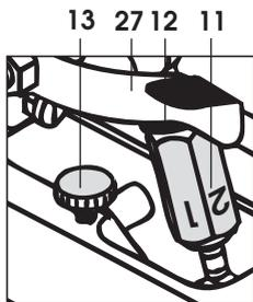
Przesunąć i wypozycjonować automat zgrzewający na materiale przeznaczonym do zgrzewania. Docisnąć **dźwignię siły docisku (10)** bez wywierania nacisku na klin kombi. Delikatnie docisnąć **rolki napędowe/dociskowe (22/23)** na materiale za pomocą **śruby regulacyjnej (11)**. Odblokować **dźwignię blokady położenia (27)** jednocześnie zwalniając **dźwignię (10)**.
