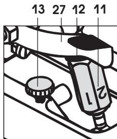
Включить и сориентировать автоматический сварочный аппарат на свариваемом материале. Затянуть **рычаг натяжения (10)** без зацепления комбинированного клина. Аккуратно затянуть **ведущие прижимные ролики (22/23)** с помощью **регулировочного винта (11)** на свариваемом материале, чтобы они слегка касались материала. Разблокировать **рычаг механизма (27)** и в то же время отжать **рычаг натяжения (10)**.
