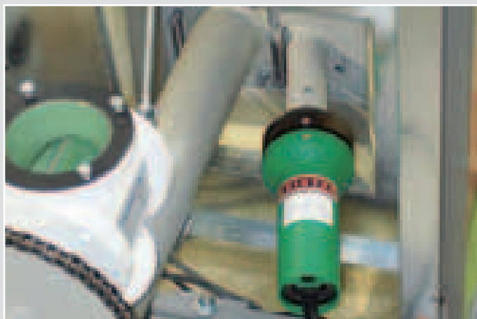
Поджиг деревянных гранул или стружки аппаратом Ляйстер TRIAC S ECONIMY.
