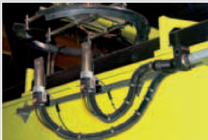
Поток горячего воздуха удаляет грат с пластмассовых деталей после формования.
