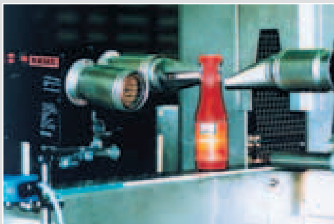
Тепловентилятор при усадке термоусадочных колпачков на бутылках.
