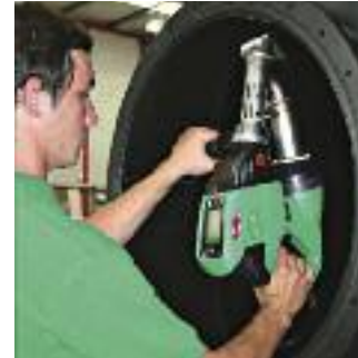
Удобный ручной сварочный экструдер WELDPLAST S2 в работе.
