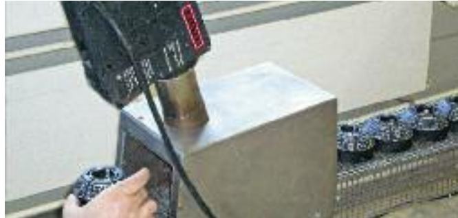
HOTWIND S на линии тампонной печати отлично подходит для сушки краски.
