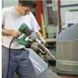
Экструдер FUSION 3C при сварке резервуара.
