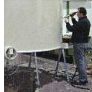
Сборка цистерны из ПП аппаратом DIODE PID, Швейцария.
