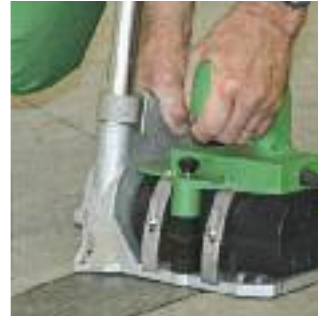
Мощный привод подходит для резки шва ПВХ, ПУ и линолеума.
