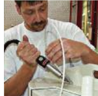
Сварка прутком с использованием компактного и легкого аппарата WELDING PEN R.
