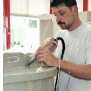
Вентилятор ROBUST подает воздух к WELDING PEN.
