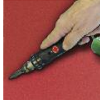
Аппарат LABOR S с MINOR в качестве внешнего источника подачи воздуха.
