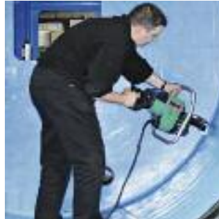
Ручной экструдер WELDPLAST S6 легко направляется при помощи практической рукоятки.
