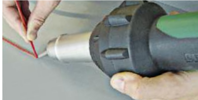
Оптимально для сварки с прутком при производстве изделий из пластмасс.
