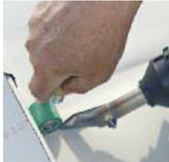
Маленький и легкий аппарат HOT JET S отлично подходит для сварки в узких местах.
