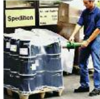
Усадка термоусадочной пленки на палетах без использования открытого пламени в закрытых помещениях.
