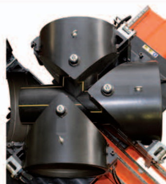
Тройник при сварке
