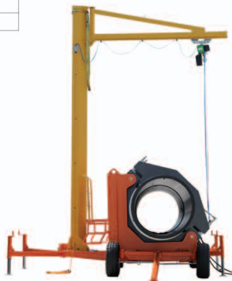
Тележка центратора и электрический кран (опция)
