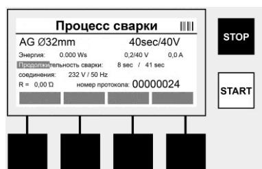
В процессе сварки все важные данные отображаются на дисплее. Процесс сварки контролируется на протяжении всего времени сварки в соответствии с параметрами, заданными в коде муфты.
