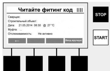
Сосканировать код муфты с помощью устройства считывания штрихкодов. Если устройство считывания штрихкодов повреждено или код муфты невозможно считать, его можно ввести вручную. Для этого необходимо нажать клавишу >ВВОД ВРУЧНЮЮ< (см. также раздел «Ввод»).
