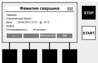
В пункте меню >СВАРКА< можно ввести необходимые для сварки данные. Для этого можно сканировать устройством считывания штрихкод или ввести его вручную многофункциональными клавишами.
