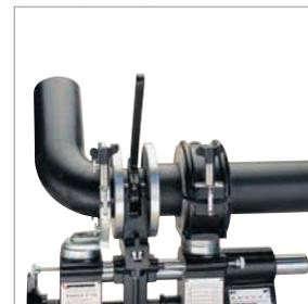
Соединение труба/фитинг с узким и широким зажимами
