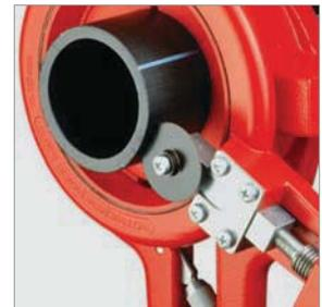
Комплект РОКАТ® 110 состоит из: пластмассового чемодана с базовым устройством (№ 5.5020), внутренним гратоснимателем (№ 5.5018), набором вкладышей, стандартным держателем с резцом (№ 5.5029).
