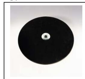
Шлифовальная сетка устанавливается на универсальном диске за счет ее сцепления с резиновой прокладкой. Войлочные круги как и сетка не фиксируются жестко на диске, для их крепления необходимо сначала закрепить на диск шлифовальную бумагу для сцепления ее с войлоком.
